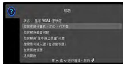
**注意：**您可以对投影机重新编程，使其在按下帮助时显示自定义的（非互动的）画面。具体步骤：在计算机上创建自定义的画面并在投影机上显示该画面，然后使用“设置”菜单中的“拍摄快照”命令。当看到“快照成功”消息时，按住帮助按钮，直至该消息消失。
